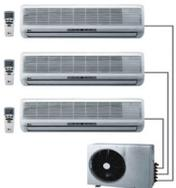
Принципиально мультисплит-система от одиночного кондиционера отличается наличием нескольких внутренних блоков. То есть посредством одной
